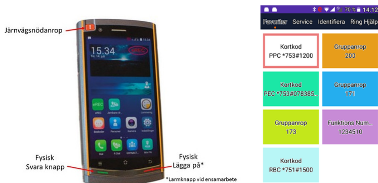
GSM-R Smartphone med dubbla SIM-kortsläsare, GSM-R och 4G/LTE.
