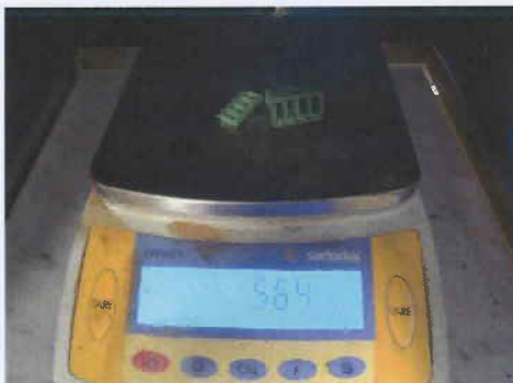
Photo 5: Phoenix Contact PC4/4-ST-7, 5.6 g
